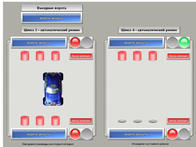
Управление транспортными шлюзами может осуществляться в ручном и в автоматическом режиме.
